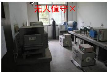
6. 电热烘箱一般只能用于烘干玻璃、金属容器和在加热过程中不分解、无腐蚀性的样品，禁止烘烤溶剂、油品等易燃、可燃挥发物或刚用乙醇、丙酮淋洗过的样品、仪器。
